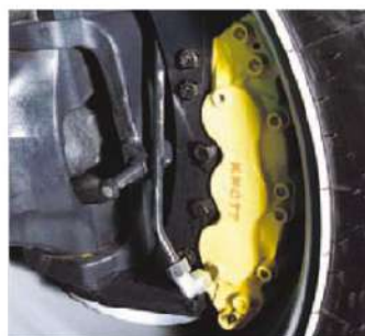
Serie 6215, Serie 7, Serie 9: Scheibenbremsen an den Vorderachsen für extrasichere Bremswirkung auch bei höchster Beanspruchung.
