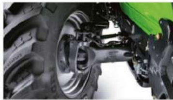
Einmalige Vorderachsfederung über Längsschwinge stufenlos
